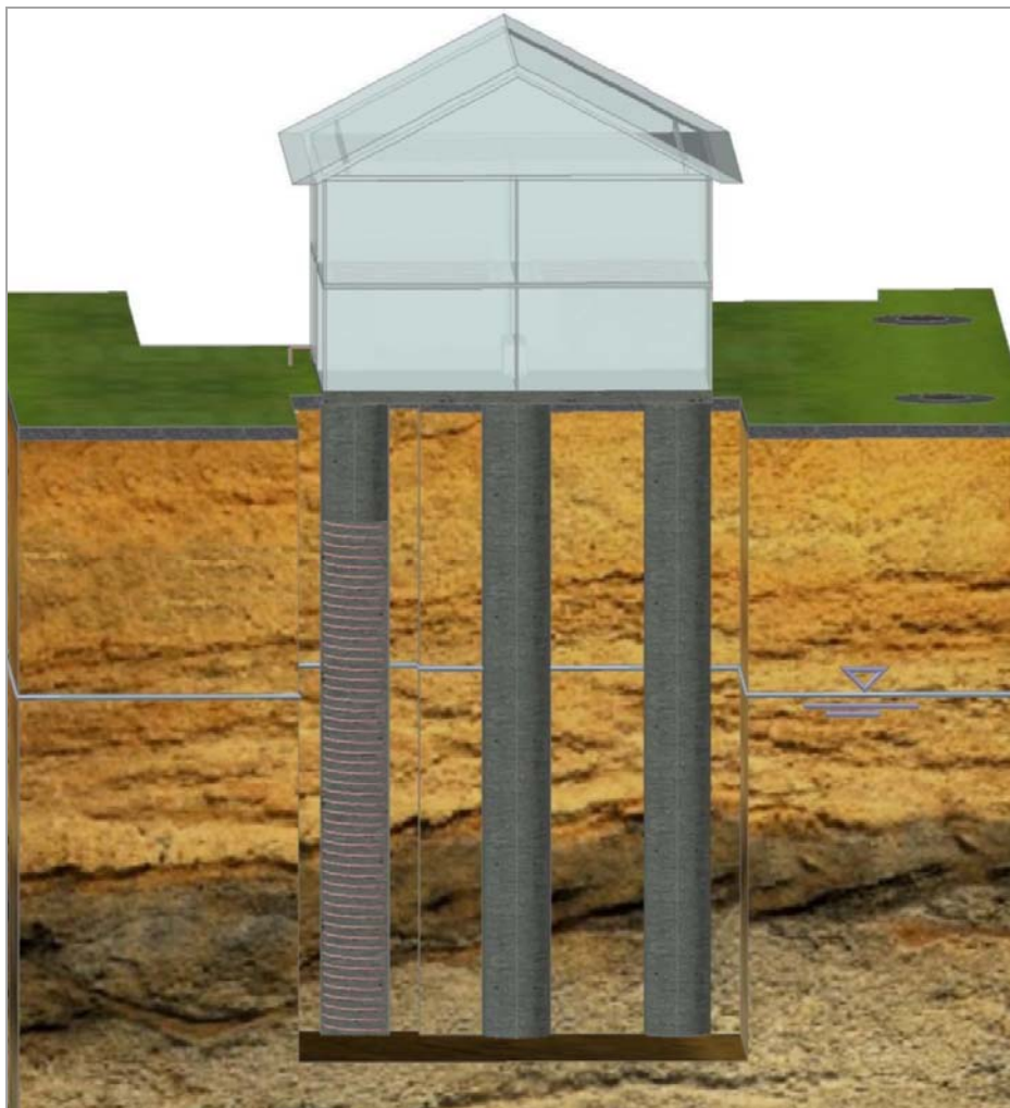
Abb. 6: Systemhaus mit aktivierten Gründungspfählen.
